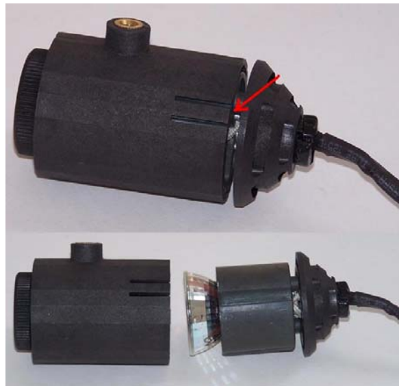
Fig. 1 Lampenwechsel des Auflichts
