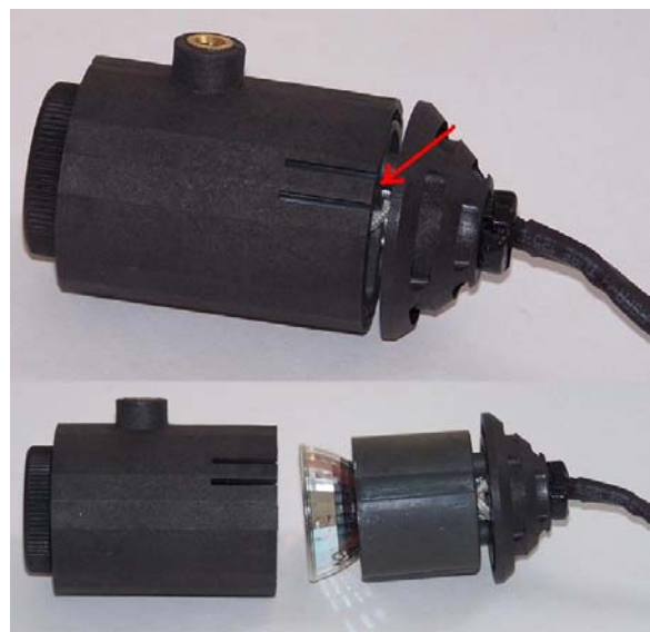
Fig. 1 Troca da lâmpada da luz incidente
