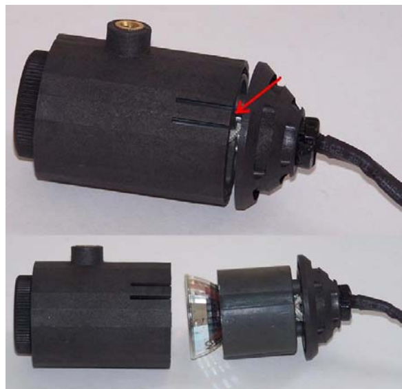
Fig. 1 Sostituzione della lampada della luce dall'alto
