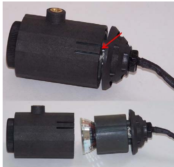
Fig. 1 Cambio de la lámpara de la luz incidente
