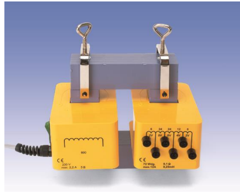
Fig.1 Transformateur de montage
