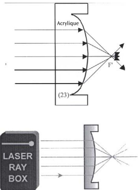
**E17a Passage de rayons lumineux à travers une lentille convexe – Rayons lumineux parallèles à l'axe optique**
