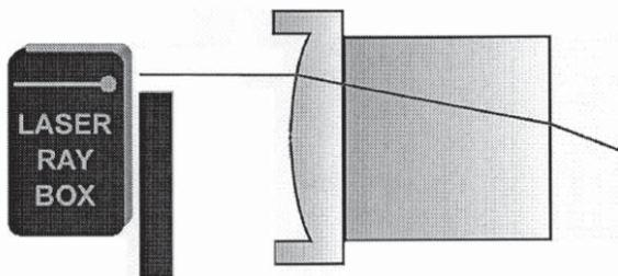
**E13b Durchgang von Lichtstrahlen durch eine konvexe Grenzfläche Luft-Acryl**
