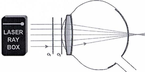
**E23a Corrección de la aberración esférica por disminución del diámetro del haz de rayos**
