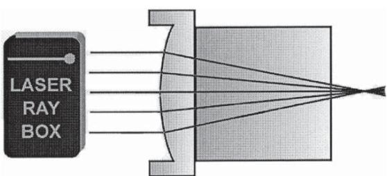
**E14a Durchgang eines Lichtstrahls durch eine konkave Grenzfläche Luft-Acryl**
