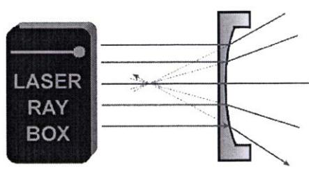
**E16a Passaggio di un fascio luminoso attraverso una superficie limite concava di acrilico-aria (U17301)**
