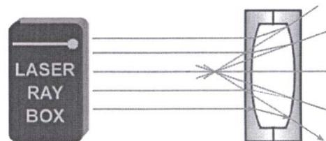
**E19b Percurso de raios luminosos através de uma lente de ar convexa – Raios luminosos não paralelos ao eixo ótico (U17301)**
