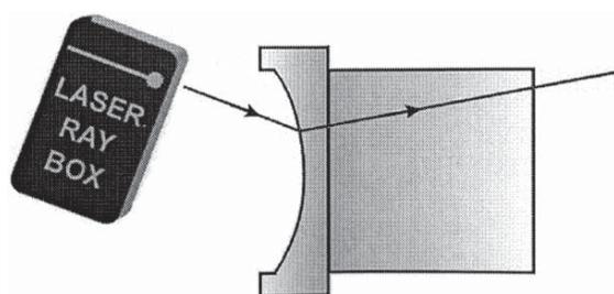
**E14b Paso de rayos de luz a través de una superficie de separación cóncava de aire-acrílico (U17301)**
