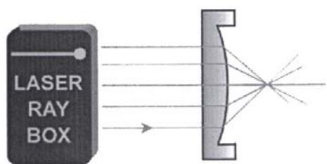
**E17a Paso de rayos de luz a través de una lente acrílica convexa – rayos de luz paralelos al eje óptico**
