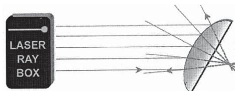
**E5a Refracción de un rayo de luz durante su paso del aire al acrílico**
