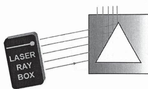
**E13a Durchgang eines Lichtstrahls durch eine konvexe Grenzfläche Luft-Acryl**
