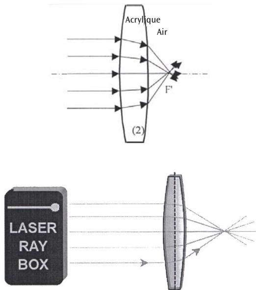
**E17b Passage de rayons lumineux à travers une lentille convexe – Rayons lumineux non parallèles à l'axe optique**
