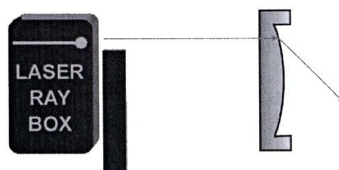
**E16b Passage de rayons lumineux à travers une surface limite concave acrylique-air**
