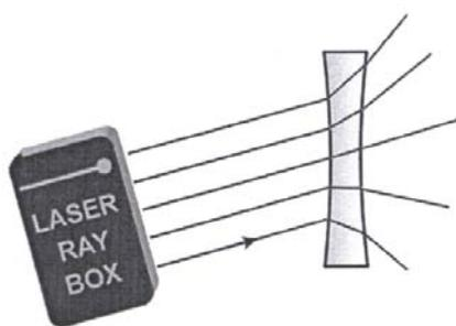
**E19a Durchgang von Lichtstrahlen durch eine konvexe Luftlinse – Lichtstrahlen parallel zur optischen Achse**
