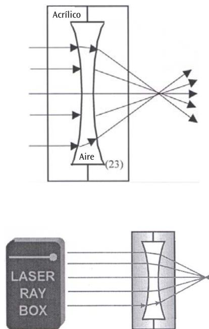
**E20b Paso de rayos de luz a través de una lente de aire cóncava – rayos de luz paralelos al eje óptico**
