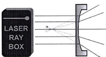
**E16a Percurso de um raio luminoso através de uma superfície de separação acrílico-ar côncava (U17301)**
