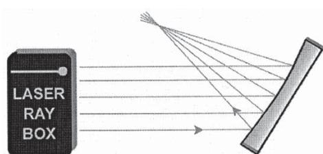
**E4a Reflexión en espejo convexo – rayos de luz paralelos al eje óptico**
