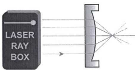
**E17a Durchgang von Lichtstrahlen durch eine konvexe Acryllinse – Lichtstrahlen parallel zur optischen Achse**
