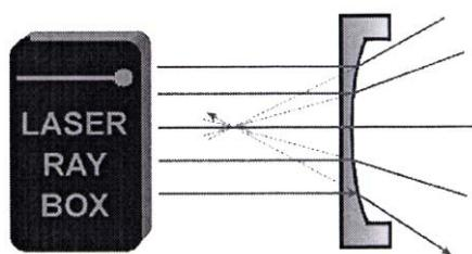
**E16a Paso de rayos de luz a través de una superficie de separación cóncava de aire-acrílico (U17301)**
