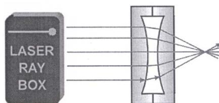
**E20b Passaggio di fasci luminosi attraverso una lente concava di aria – fasci luminosi paralleli all'asse ottico**
