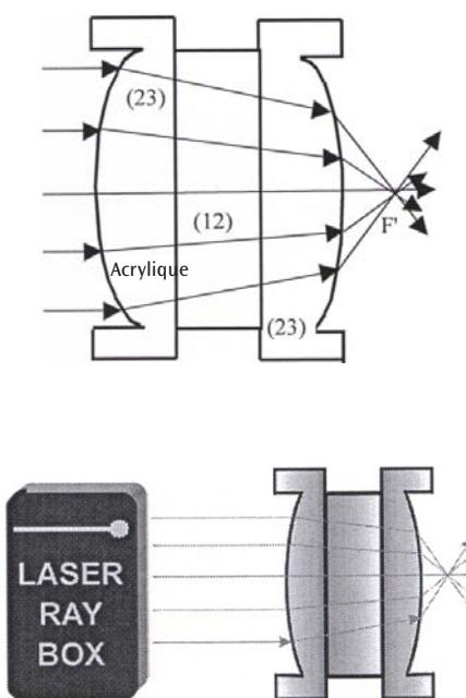
**E18a Passage de rayons lumineux à travers une lentille concave – Rayons lumineux parallèles à l'axe optique**
