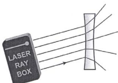
**E19a Percurso de raios luminosos através de uma lente de ar convexa – Raios luminosos paralelos ao eixo ótico (U17301)**
