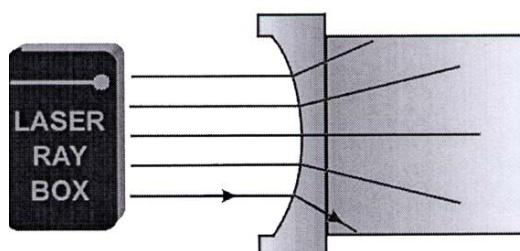
**E14a Passaggio di un fascio luminoso attraverso una superficie limite concava di aria-acrilico (U17301)**
