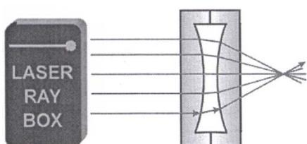
**E20b Percurso de raios luminosos através de uma lente de ar côncava – Raios luminosos paralelos ao eixo ótico**
