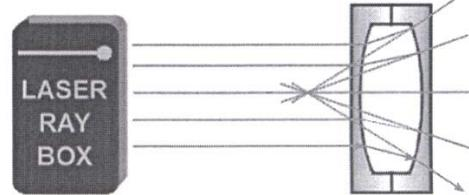
**E19b Passage de rayons lumineux à travers une lentille d'air convexe – Rayons lumineux non parallèles à l'axe optique**
