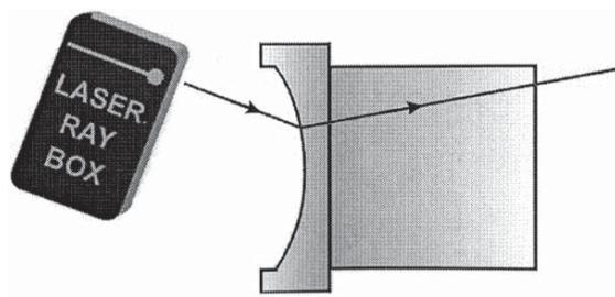
**E13b Passaggio di fasci luminosi attraverso una superficie limite convessa di aria-acrilico (U17301)**
