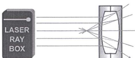
**E19b Passaggio di fasci luminosi attraverso una lente convessa di aria – fasci luminosi non paralleli all'asse ottico**
