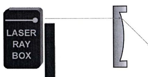
**E16b Percurso de um raio luminoso através de uma superfície de separação acrílico-ar côncava**
