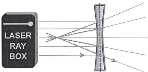
**E18b Paso de rayos de luz a través de una lente acrílica cóncava – rayos de luz no paralelos al eje óptico (U17300/U17301)**
