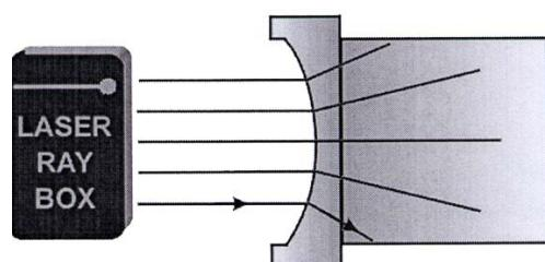
**E15a Durchgang eines Lichtstrahls durch eine konvexe Grenzfläche Acryl-Luft**
