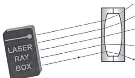
**E20a Passaggio di fasci luminosi attraverso una lente concava di aria – fasci luminosi paralleli all'asse ottico**
