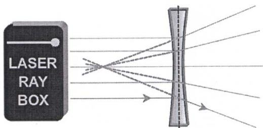
**E18b Percurso de raios luminosos através de uma lente de acrílico côncava – Raios luminosos não paralelos ao eixo ótico (U17300/U17301)**
