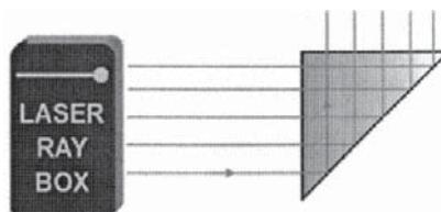
**E11b Réflexion sur deux arêtes d'un prisme acrylique**
