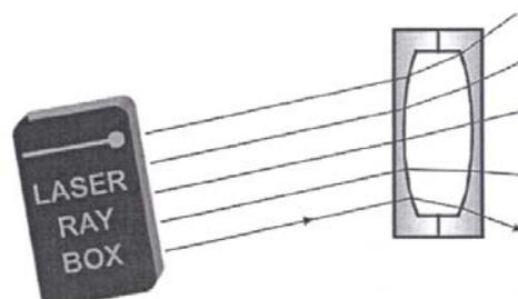
**E20a Passage de rayons lumineux à travers une lentille d'air concave – Rayons lumineux parallèles à l'axe optique**
