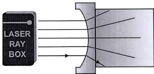
**E15a Passage d'un rayon lumineux à travers une surface limite convexe acrylique-air**
