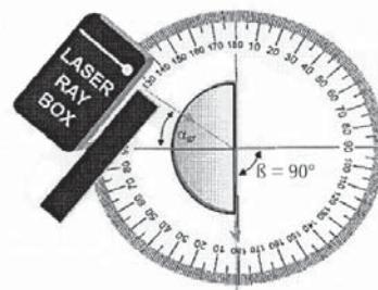
**E6d Reflexão total – Propagação da luz em condutores de luz**
