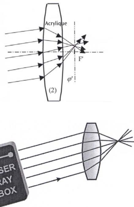
**E17c Passage de rayons lumineux à travers une lentille acrylique convexe épaisse**
