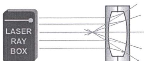
**E19b Durchgang von Lichtstrahlen durch eine konvexe Luftlinse – Lichtstrahlen nicht parallel zur optischen Achse**
