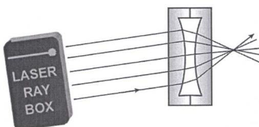
**E21a Parâmetros de lentes grossas – Determinação do raio de curvatura**
