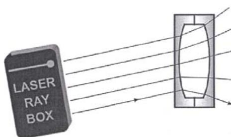
**E20a Paso de rayos de luz a través de una lente de aire cóncava – rayos de luz paralelos al eje óptico**
