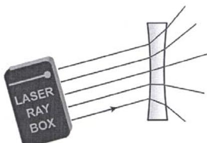
**E19a Paso de rayos de luz a través de una lente de aire convexa – rayos de luz paralelos al eje óptico (U17301)**
