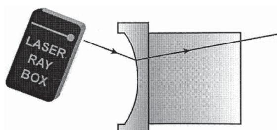
**E14b Percurso de um raio luminoso através de uma superfície de separação ar-acrílico côncava (U17301)**
