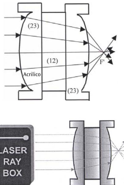
**E18a Passaggio di fasci luminosi attraverso una lente concava di acrilico – fasci luminosi paralleli all'asse ottico**
