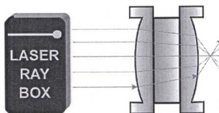
**E18a Paso de rayos de luz a través de una lente acrílica cóncava – rayos de luz paralelos al eje óptico (U17300/U17301)**
