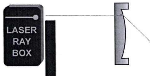
**E16b Paso de rayos de luz a través de una superficie de separación cóncava de acrílico-aire**
