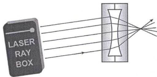
**E21a Parametri di lenti spesse – determinazione del raggio di curvatura**
