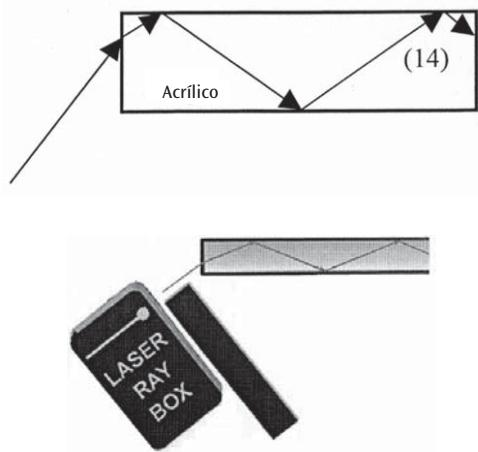
**E7 Deslocamento de um raio luminoso, placa de acrílico plano paralela**
