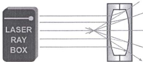
**E19b Paso de rayos de luz a través de una lente de aire convexa – rayos de luz no paralelos al eje óptico (U17301)**
