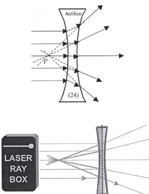
**E18b Passaggio di fasci luminosi attraverso una lente concava di acrilico – fasci luminosi non paralleli all'asse ottico**
