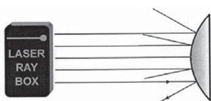
**E4b Reflexión en espejo convexo – rayos de luz no paralelos al eje óptico**
