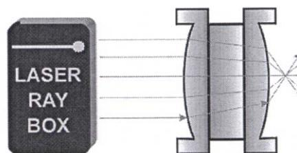
**E18a Percurso de raios luminosos através de uma lente de acrílico côncava – Raios luminosos paralelos ao eixo ótico (U17300/U17301)**
