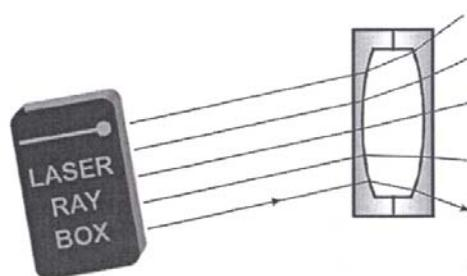
**E20a Percurso de raios luminosos através de uma lente de ar côncava – Raios luminosos paralelos ao eixo ótico**
