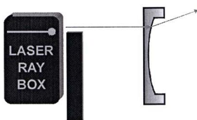
**E15b Passaggio di fasci luminosi attraverso una superficie limite convessa di aria-acrilico (U17301)**
