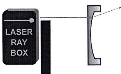
**E15b Paso de rayos de luz a través de una superficie de separación convexa de acrílico-aire (U17301)**
