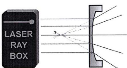
**E16a Durchgang eines Lichtstrahls durch eine konkave Grenzfläche Acryl-Luft**
