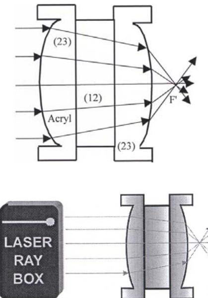
**E18a Durchgang von Lichtstrahlen durch eine konkave Acryllinse – Lichtstrahlen parallel zur optischen Achse**
