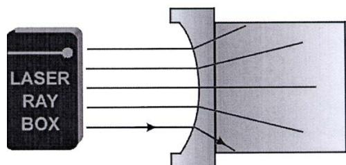
**E15a Percurso de um raio luminoso através de uma superfície de separação acrílico-ar convexa (U17301)**
