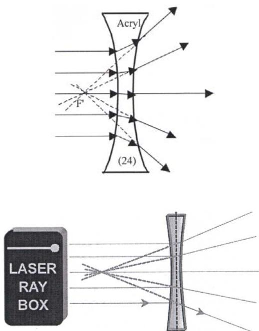
**E18b Durchgang von Lichtstrahlen durch eine konkave Acryllinse – Lichtstrahlen nicht parallel zur optischen Achse**
