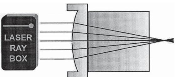
**E14b Passaggio di fasci luminosi attraverso una superficie limite concava di aria-acrilico (U17301)**
