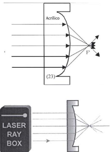
**E17a Percurso de raios luminosos através de uma lente de acrílico convexa – Raios luminosos paralelos ao eixo ótico**
