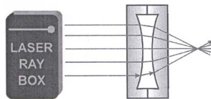
**E20b Durchgang von Lichtstrahlen durch eine konkave Luflinse – Lichtstrahlen parallel zur optischen Achse**
