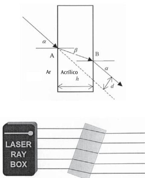
**E8 Deslocamento de um raio luminoso, ar entre duas placas de acrílico plano paralelas**
