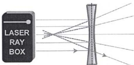
**E18b Passage de rayons lumineux à travers une lentille concave – Rayons lumineux non parallèles à l'axe optique**
