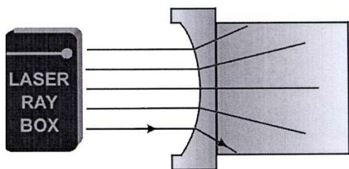
**E15a Paso de un rayo de luz a través de una superficie de separación convexa de aire-acrílico (U17301)**
