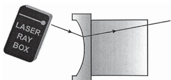
**E14b Passage de rayons lumineux à travers une surface limite concave air-acrylique**
