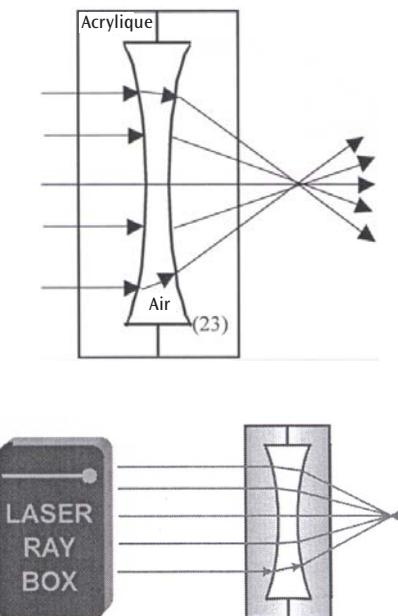
**E20b Passage de rayons lumineux à travers une lentille d'air concave – Rayons lumineux parallèles à l'axe optique**
