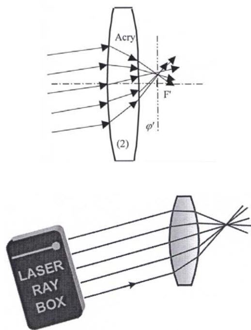
**E17c Durchgang von Lichtstrahlen durch eine dicke konvexe Acryllinse**
