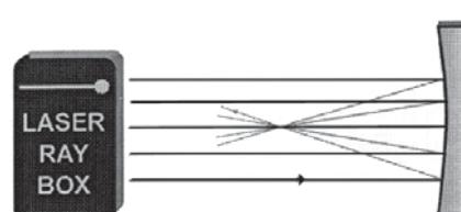
**E3b Reflexión en un espejo cóncavo – rayos de luz no paralelos al eje óptico**
