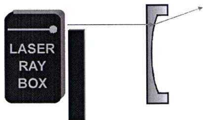
**E15b Durchgang von Lichtstrahlen durch eine konvexe Grenzfläche Acryl-Luft**
