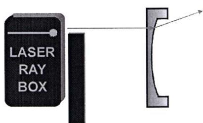
**E15b Percurso de um raio luminoso através de uma superfície de separação acrílico-ar convexa (U17301)**
