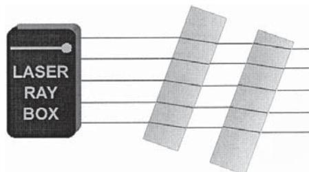
**E9a Desvio de um raio luminoso através de um prisma de acrílico**
