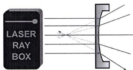
**E16a Passage d'un rayon lumineux à travers une surface limite concave acrylique-air**
