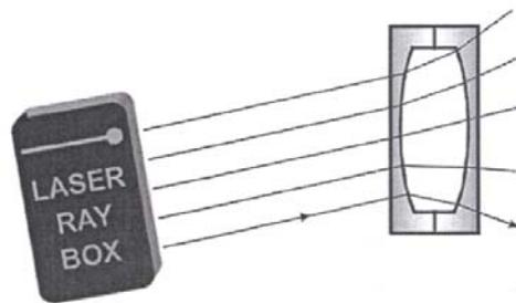
**E20a Durchgang von Lichtstrahlen durch eine konkave Luftlinse – Lichtstrahlen parallel zur optischen Achse**
