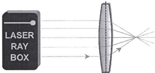
**E17b Paso de rayos de luz a través de una lente acrílica convexa – rayos de luz no paralelos al eje óptico** (U17300/U17301)
