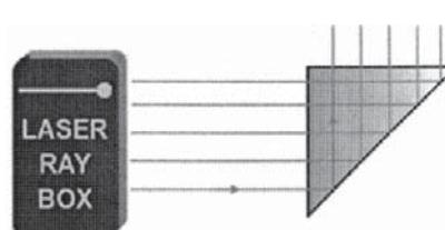
**E11b Reflexão em duas arestas de um prisma de acrílico (U17301)**
