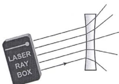
**E19a Passage de rayons lumineux à travers une lentille d'air convexe – Rayons lumineux parallèles à l'axe optique**
